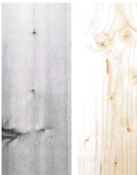
Tv. Fyr med knaster i grenkranse, her med en død og delvist løs knast. Th. gran med stor knastgruppe og spredte små perleknaster.
