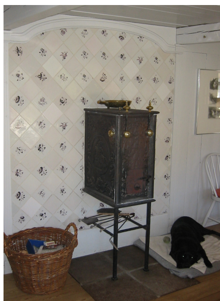
Bilæggerovn. Støbejernsovnen har indfyrringshul fra køkkenildstedet og kan derfor ikke åbnes fra stuen, hvilket bevirker, at der heller ikke kommer røg, aske eller støv ud, kun varme, når den er tændt.
