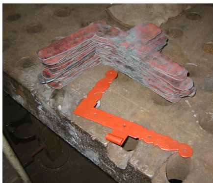
Kopier af vinduesbeslag fra 1750'erne udført i smedjen i Raadvad. Beslagene essesmedes på samme måde som oprindeligt, hvilket betyder at de bliver meget kompakte i strukturen, og derfor meget holdbare. Grovformen smedes ud, hvorefter den præcise form og detaljering hugges ud i det glødende jern.
