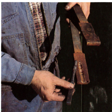
Hamborghængsel fra ca. 1900 har typisk sænkesmedede hængseltoppe/knopper. Billedet viser det sænkeværktøj, smeden bruger til at fremstille de sænkesmedede knopper.
