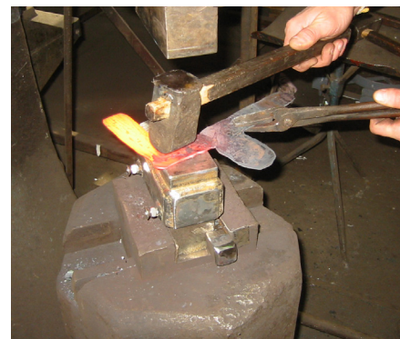
Kopier af vinduesbeslag fra 1750'erne udført i smedjen i Raadvad. Beslagene essesmedes på samme måde som oprindeligt, hvilket betyder at de bliver meget kompakte i strukturen, og derfor meget holdbare. Grovformen smedes ud, hvorefter den præcise form og detaljering hugges ud i det glødende jern.
