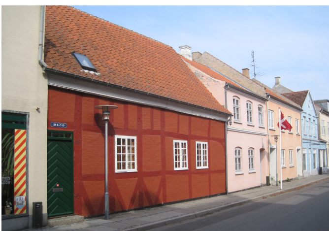
Gadeforløb i Nysted, hvor en gammelrosa facadefarve er et af de lokale særpræg. Ved at studere en gammel farve fra et stykke originalt puds kan man få fremstillet en prøvebrik med denne farve – der efterfølgende kan bruges til at farvesætte husfacaden.
