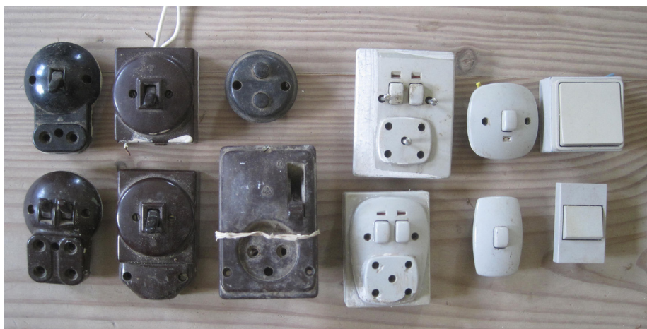
Øverst: Danske el-kontakter fra ca. 1900 – 1930 i messing eller brun, sort eller hvid bakelit på en hvid eller sort porcelænsfatning. Efter et sikkerhedscheck kan disse evt. stadig anvendes. Nederst: Danske el-kontakter fra 1930 – 1980 i brun eller sort bakelit – efter 1950 i grå plastik. Den lille runde funkis-afbryder kunne abnringes på selve gerichten/dørindfatningen, der samtidigt blev udført plan, uden profileringer.
