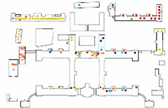
Ca. placering af taghætter og ventilationskorstene
