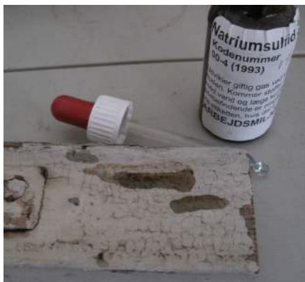
Test af forekomsten af blyhvidt med natriumsulfid. Væsken farves sort, og testen lugter kraftigt af svovl. Bemærk også slangeskindskrakeleringen, der er typisk for blymønje. Zinkhvidt har lidt større og aflange flager.
