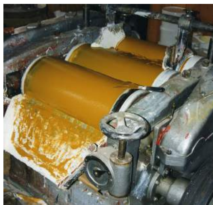
Rivning af guldokkerfarvet linoliemaling på en trevalse. Rivning på trevalse forbedrer linoliemalingens kvalitet, da alle luftbobler i pigmenterne rives ud. Foto: Anne Lindegaard
