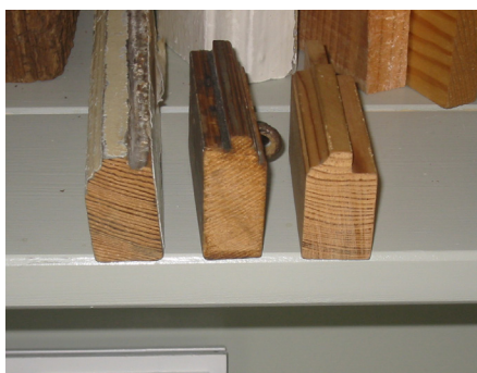
Spejlskårne vinduesrammer. Træets marvstråler ligger parallelt med rammernes yderside.
