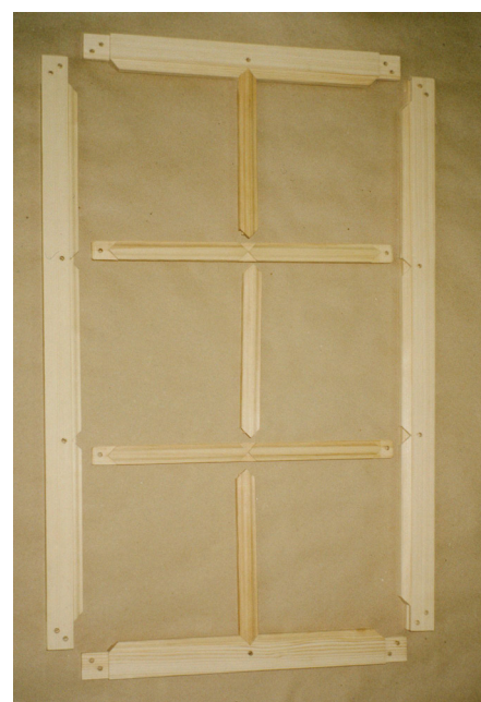
En vinduesramme med kontrakehede samlinger, fæstnet med to trædyvler i hjørnerne, uden lim
