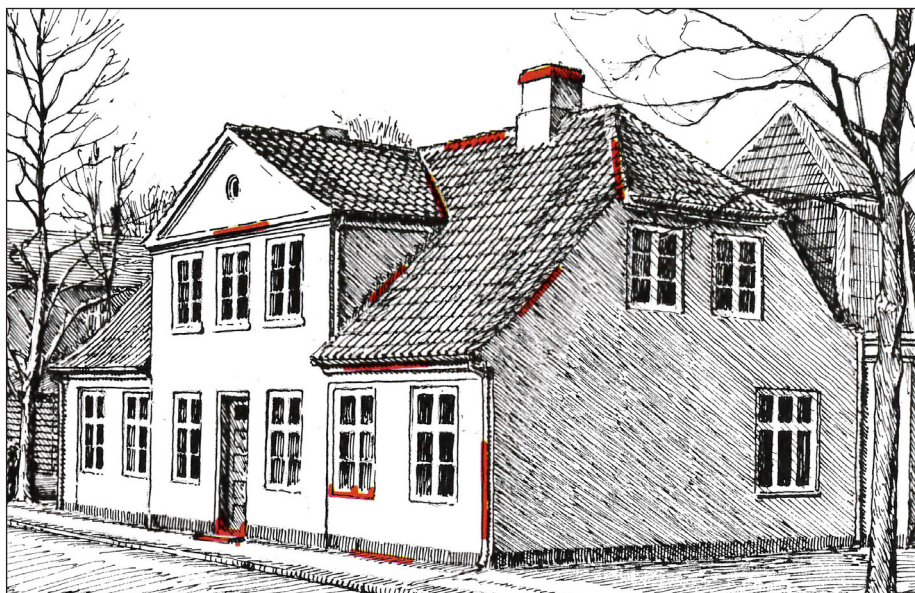
Heller forebygge end helbrede. Sårbare steder på et ældre hus, hvor der skal udvises særlig opmærksomhed (mærket med rødt)
