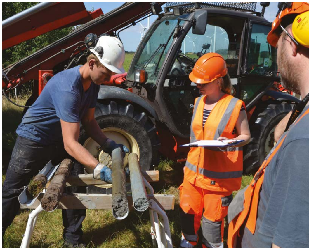
Fig. 1. Boreprøver efter den hollandske metode bliver her anvendt i Rødby ved Femern-undersøgelserne.
