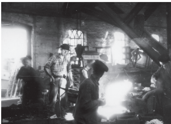
Der arbejdes ved smeltedigelen, Faaborg Jernstøberi.
