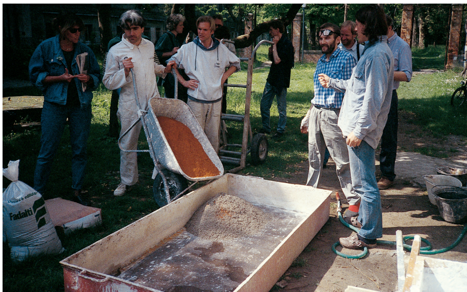
Fremstilling af hydraulisk kalk ved at blande knust teglsten i luftkalk. Restaureringscenteret på San Servolo i Venezia
