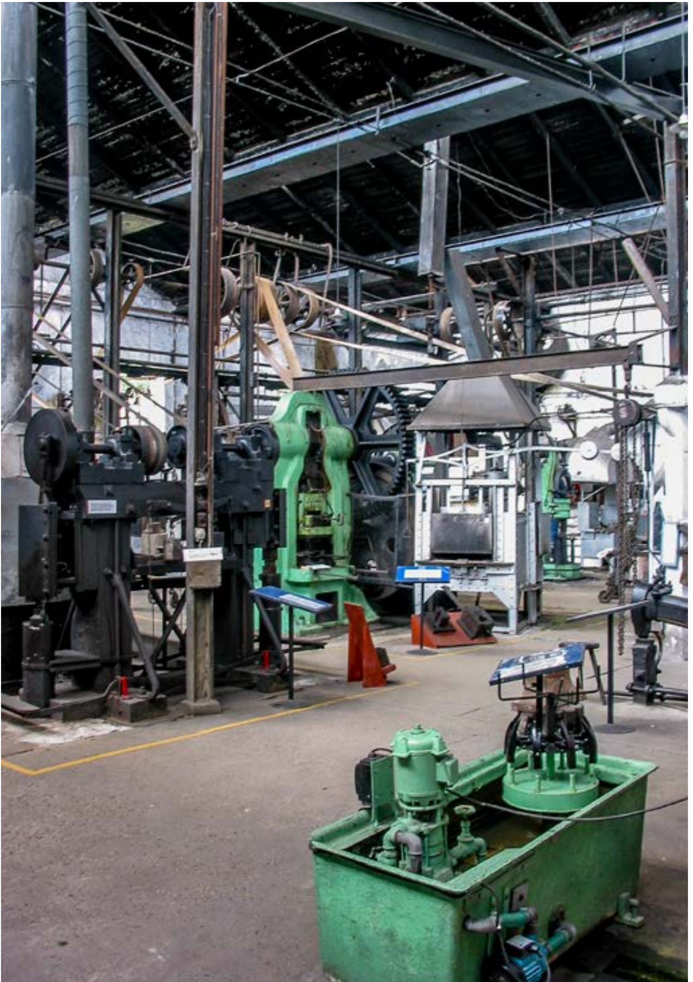
I den mindre smedje ved Godthaab Hammerværk syd for Aalborg, der drives som museum, er der bevaret fjedrehamre og andre maskiner.
