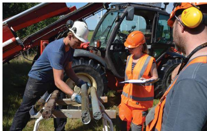
Fig. 1. Boreprøver efter den hollandske metode bliver her anvendt i Rødby ved Femern-undersøgelserne. Foto: Lolland-Falsters Museum
